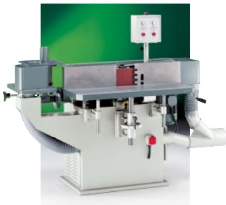
Levigatrice combinata a più lavorazioni, a nastro abrasivo oscillante modello LBK. Una caratteristica di base è l'oscillazione indipendente di tutto il gruppo levigante che, oltre ad evitare l'intasamento del nastro abrasivo, offre pregevoli finiture.
