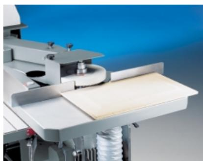
*Ausführung mit neigbarem, horizontal und vertikal verstellbarem Tisch (mit Schnellverstellhebel) für Arbeiten an der gummierten Bandantriebswalze und für den Gebrauch von Schleifrädern und Profilscheiben.*
